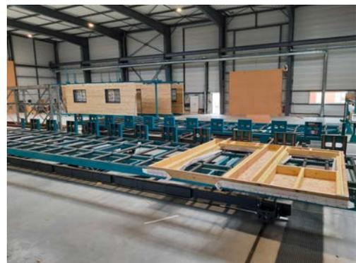
Le poste bardage, conçu pour permettre à nos charpentiers de poser et clouer le bardage à hauteur d'homme, sans fatigue dans un confort de travail et en toute sécurité.
