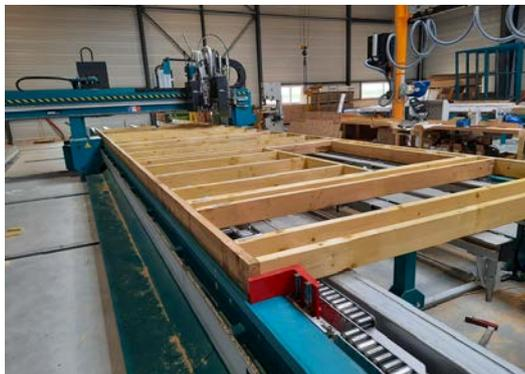
La machine d'assemblage V4-2, conçue et fabriquée en France par la marque Mach Diffusion, est une machine à commande numérique qui nous permet de fabriquer rapidement et dans des conditions optimales nos murs, caissons de plancher et de toiture en ossature bois, avec une capacité de production atteignant près de 140 m<sup>2</sup> de murs par jour.
