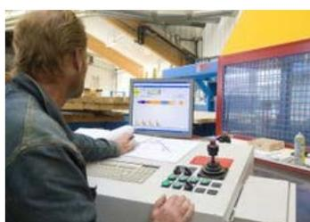
Deux machines à commande numérique de marque Hundegger la K2i pour la taille des bois massifs et la SPM pour la taille des panneaux, permettent à nos opérateurs, tous charpentiers de métier, d'assurer un travail de qualité et de précision.
